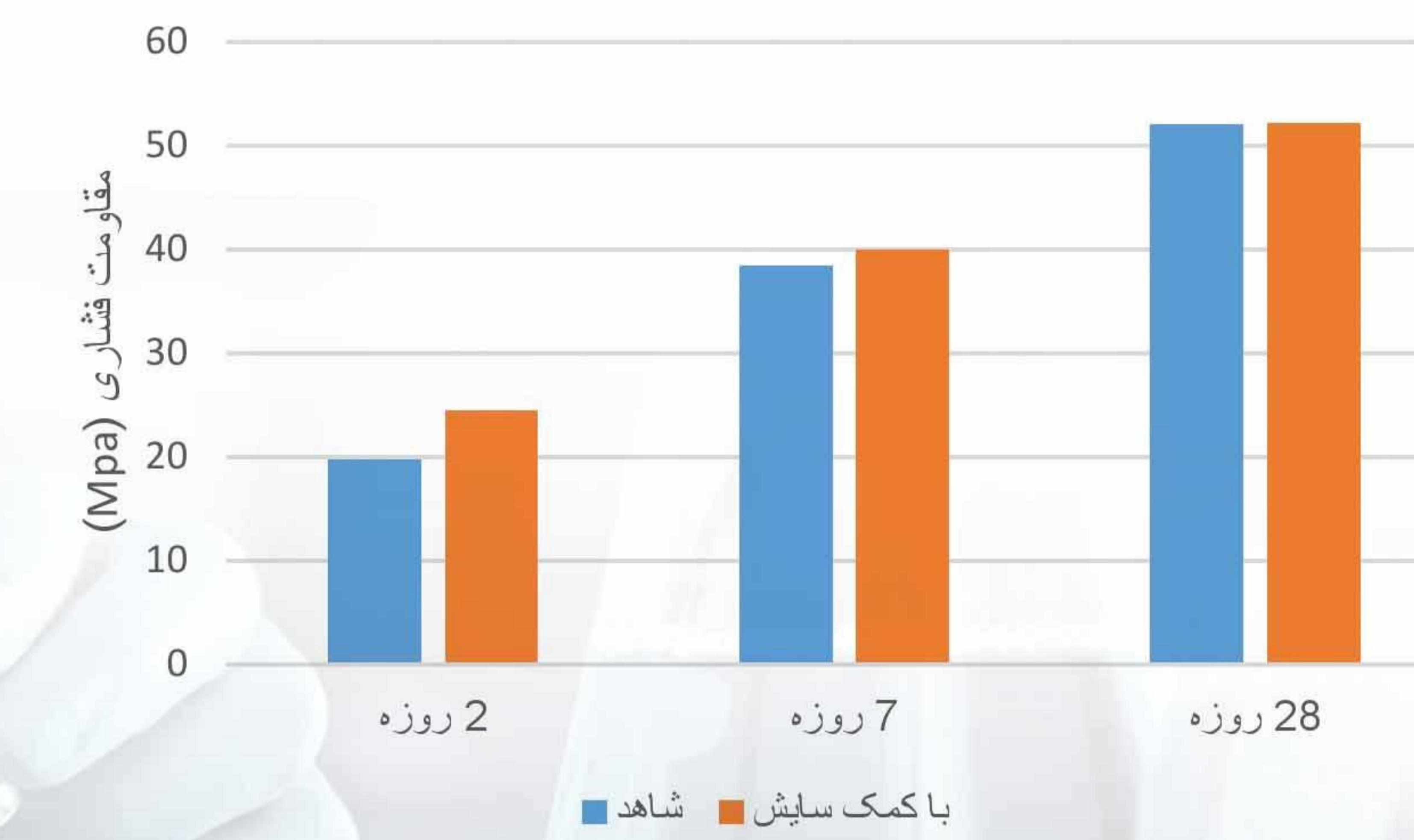
اثر کمک سایش بر مقاومت فشاری
