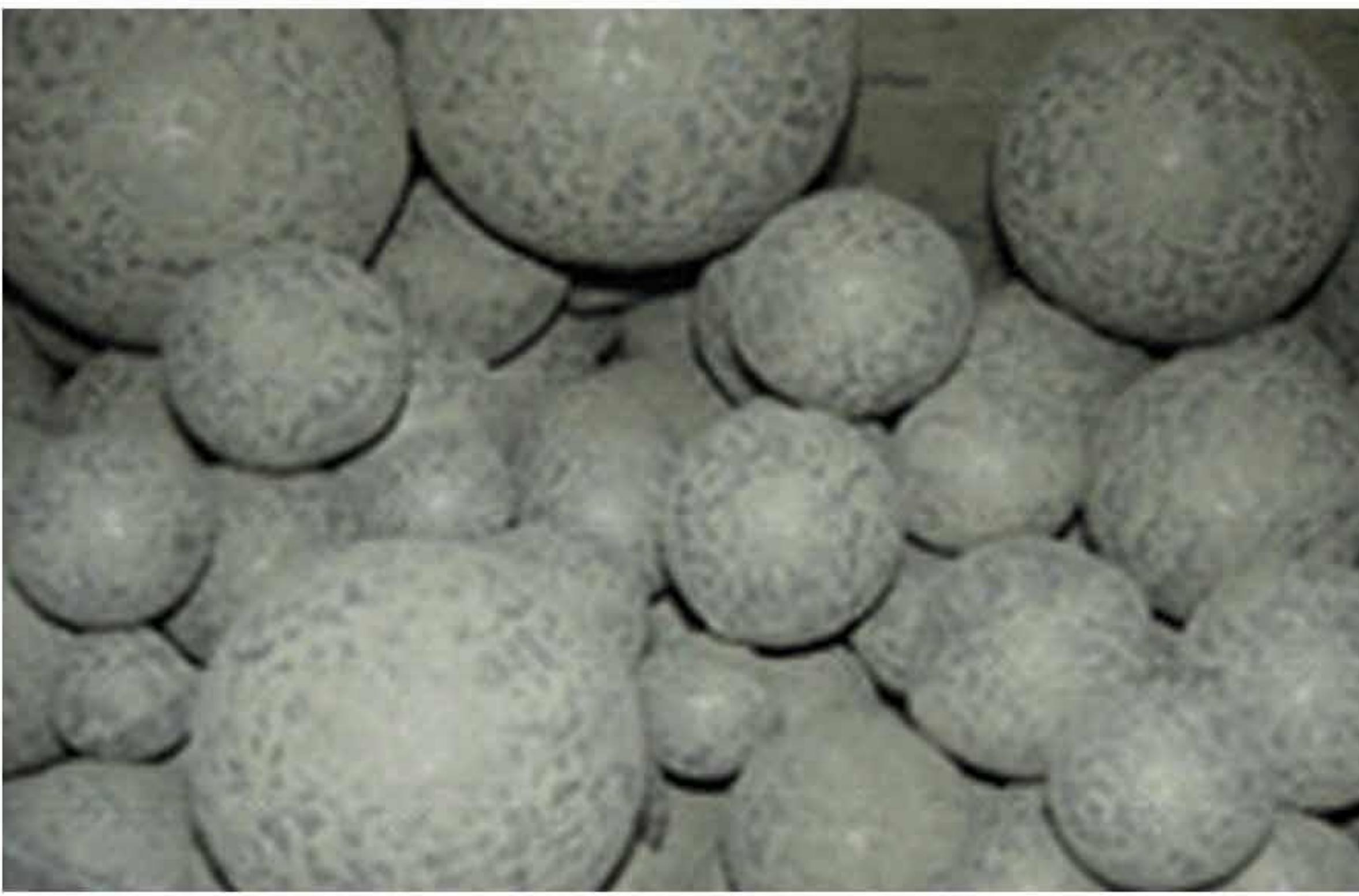
پوشش سیمانی ایجاد شده بر روی گلوله‌های آسیا و افزایش آسیا در حالت عدم استفاده از کمک سایش
