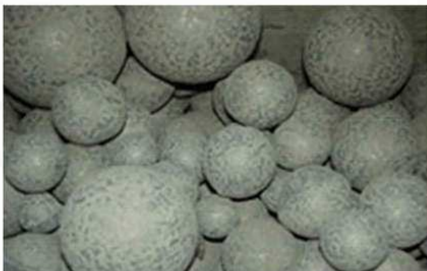
Цементное коатинг (покрытие), создаваемое на мелющие шары при отсутствии интенсификатора помола
