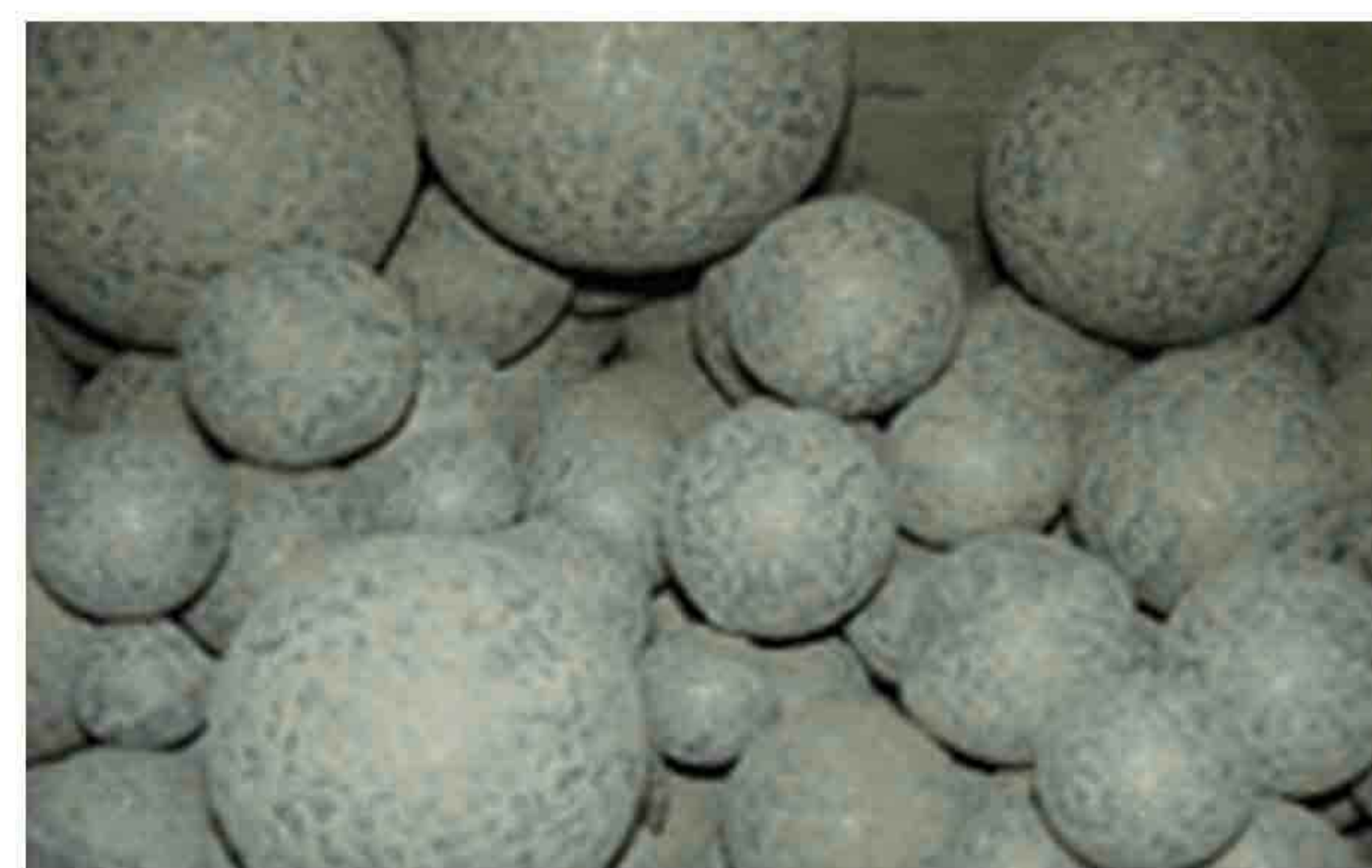
پوشش سیمانی ایجاد شده بر روی گلوله‌های آسیا در صورت عدم استفاده از کمک‌سایش
