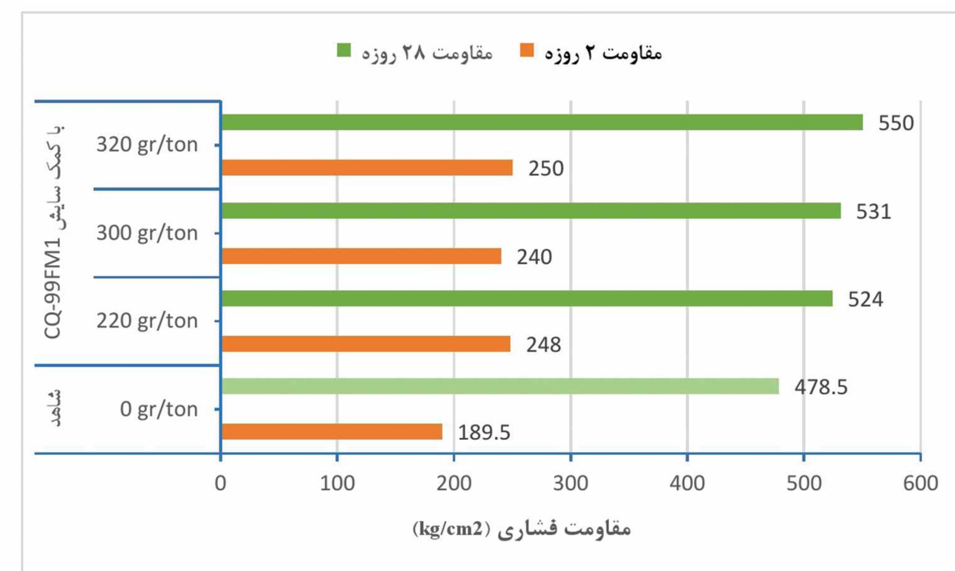
شکل ۲۳- افزایش مقاومت فشاری سنین ۲ و ۲۸ روزه ملات سیمان با استفاده از محصول کمک‌سایش پارس‌مان شیمی - تست صنعتی در آسیای غلطکی
