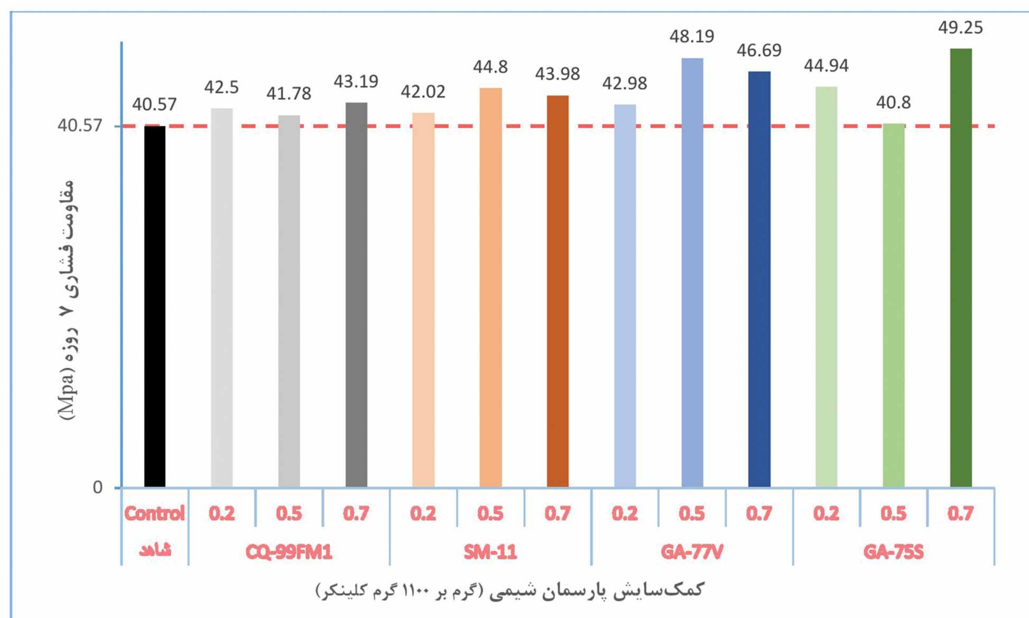
شکل ۱۴- مقاومت ۷ روزه نمونه‌های ملات سیمان ساخته شده با دزهای مختلف محصولات کمکسایش پارسمان شیمی در قیاس با نمونه شاهد
