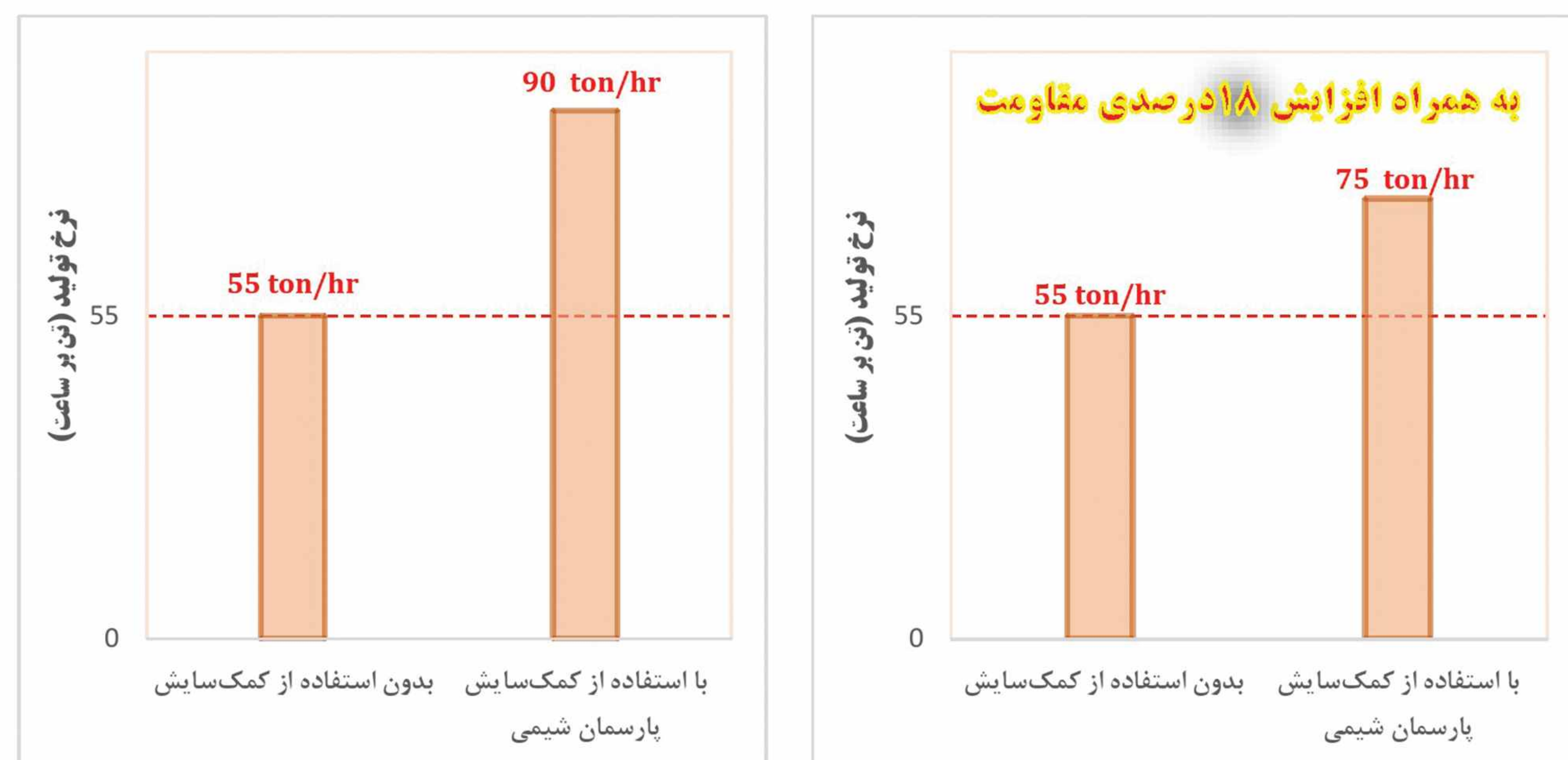
شکل ۱۷- نمودار رشد نرخ تولید با استفاده از محصول کمکسایش پارسمان شیمی - تست صنعتی در آسیای گلوله‌ای
