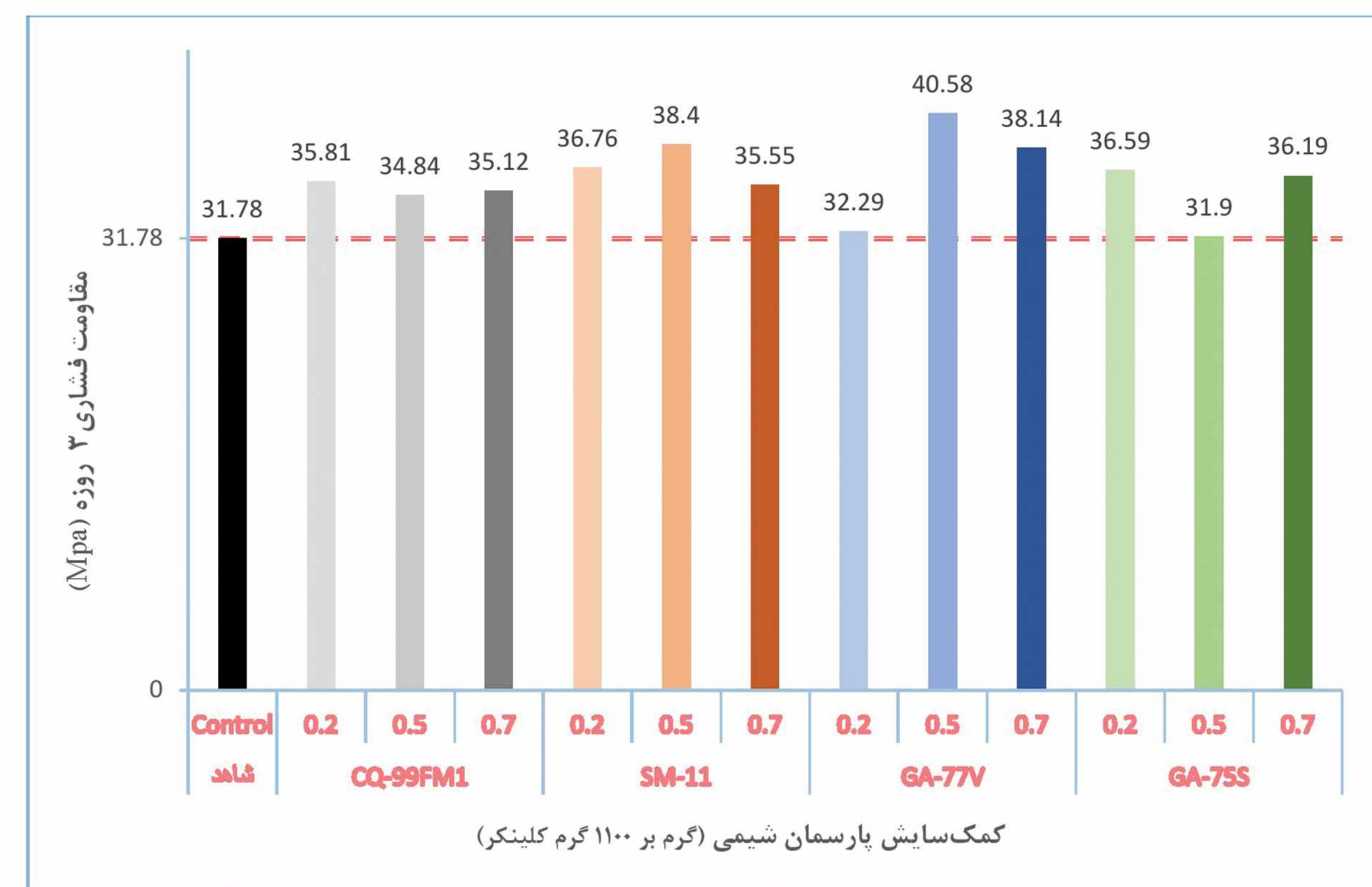
شکل ۱۳- مقاومت ۳ روزه نمونه‌های ملات سیمان ساخته شده با دزهای مختلف محصولات کمکسایش پارسمان شیمی در قیاس با نمونه شاهد
